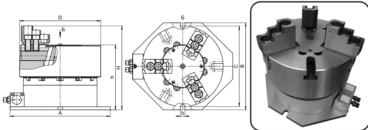
Приспособления пневматические зажимные предназначены для выполнения работ на станках сверлильно-фрезерной группы. Представляют собой токарный клиновой механизированный патрон, закрепленный на гильзе пневмоцилиндра через переходной фланец. Перемещение тяги штока патрона производится посредством подачи сжатого воздуха в полости пневмоцилиндра через коллектор. В коллектор встроен пневмозамок, обеспечивающий поддержание силы зажима детали (заготовки) в патроне.
