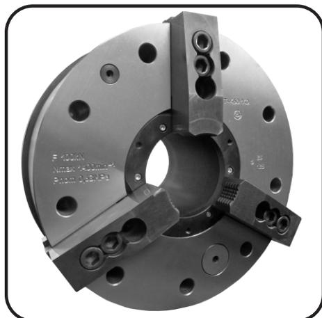
Патроны предназначены для обработки труб в нефте- и газодобывающей промышленности на специальных токарных станках. Наличие встроенного пневмопривода позволяет производить установку на станок двух патронов (на переднем и заднем конце шпинделя токарного станка) для лучшей центровки заготовки трубы. Патрон комплектуется коллектором, который крепится на передней бабке станка.
